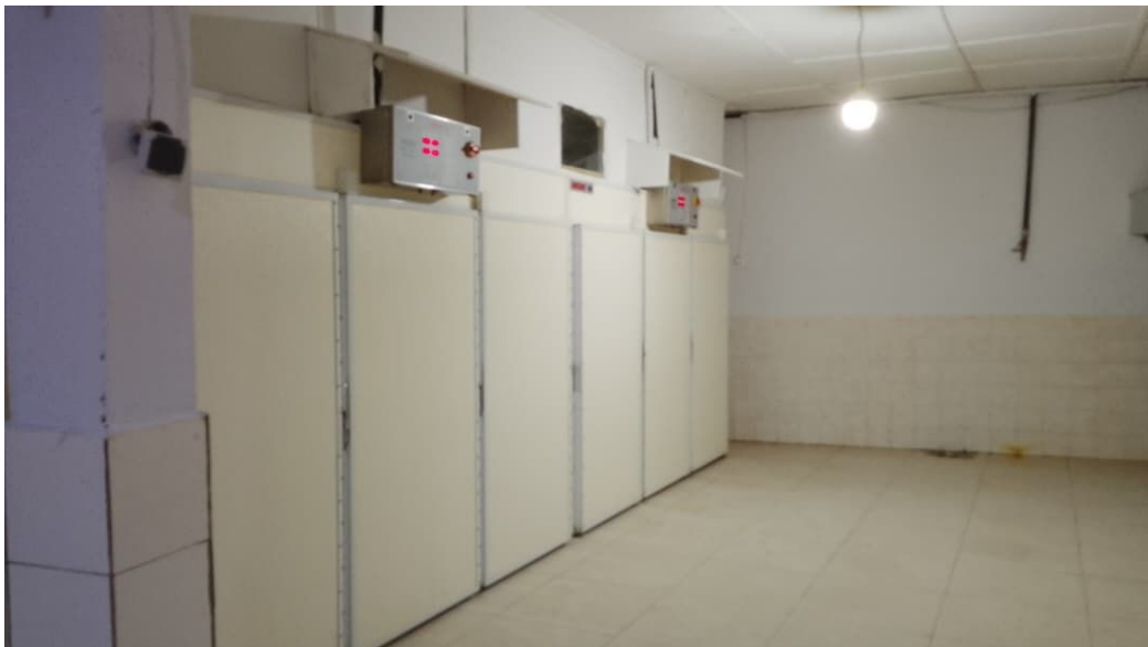
La salle d'incubation : température, humidité et retournement des œufs contrôlés jusqu'à l'éclosion.
