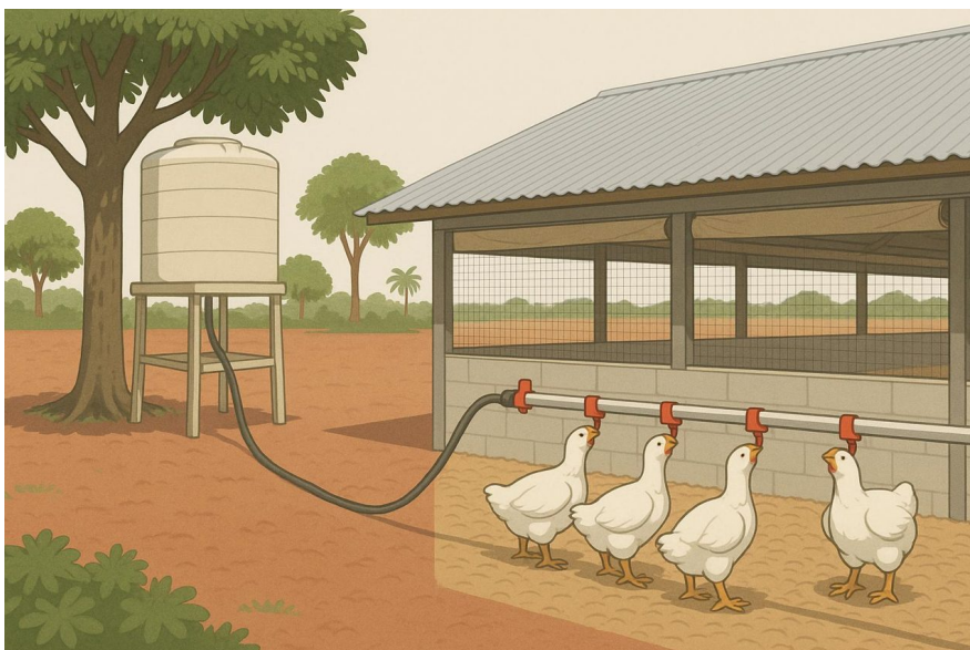
Réserve d'eau à l'ombre, tuyau enterré, ligne de pipettes réglée à hauteur de tête. — Illustration NEXTEKCI
